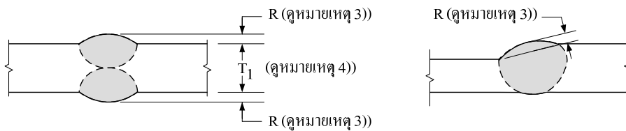
รอยเชื่อมแบบต่อชน (Butt Weld) กรณีความหนาโลหะงานเท่ากัน
